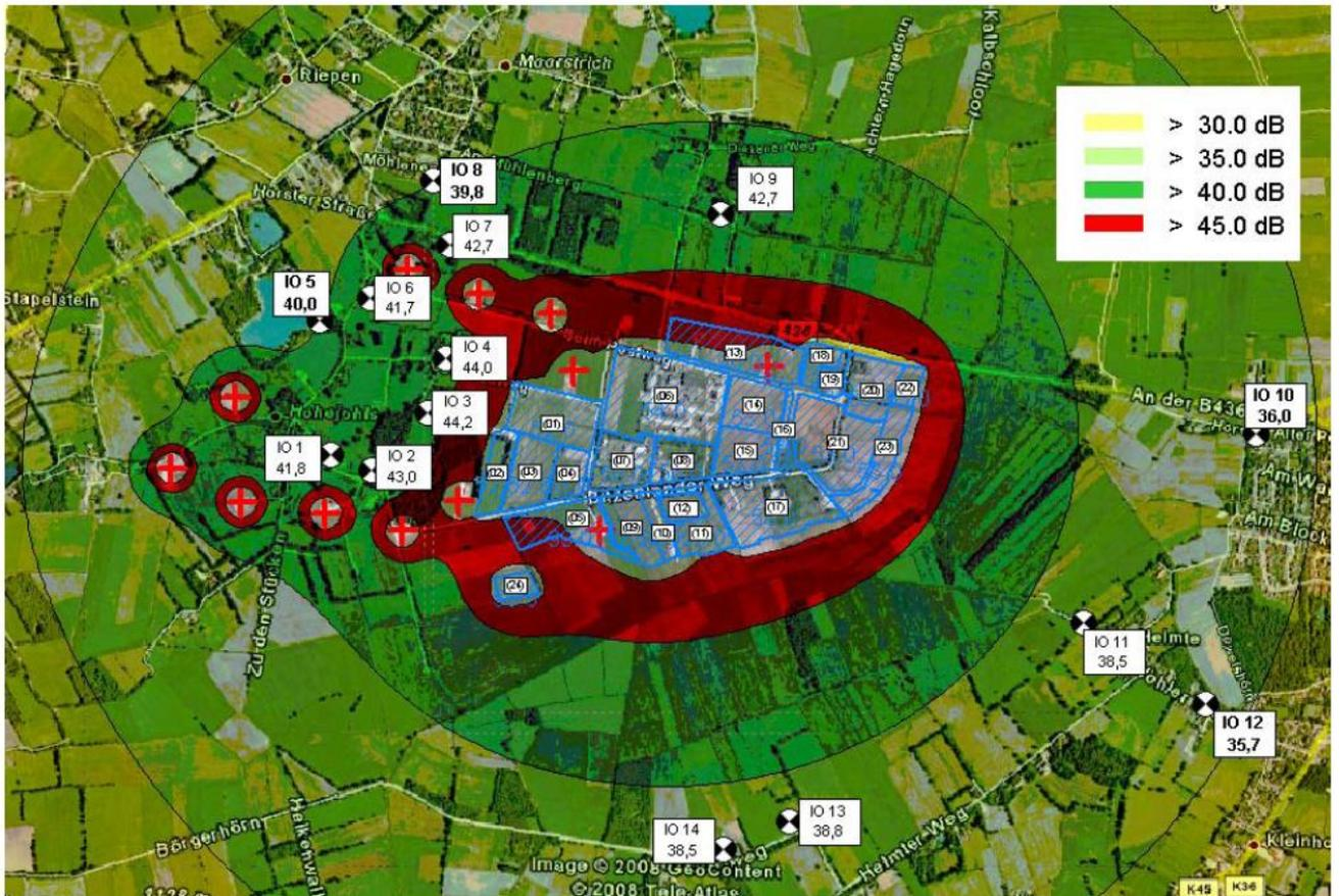
Abbildung 6. Pegelkarte für den Nachtzeitraum, berechnet nach DIN 45691 [1] mit den Emissionsdaten aus Tabelle 1 (ohne Richtungssektoren) unter Berücksichtigung der Vorbelastung durch die existierenden Gaskavernen (rote Kreuze)
