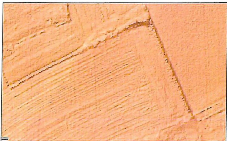
Abbildung 2: Dig. Geländemodell: Wallkörper an der nördlichen und östlichen Geltungsbereichsgrenze
