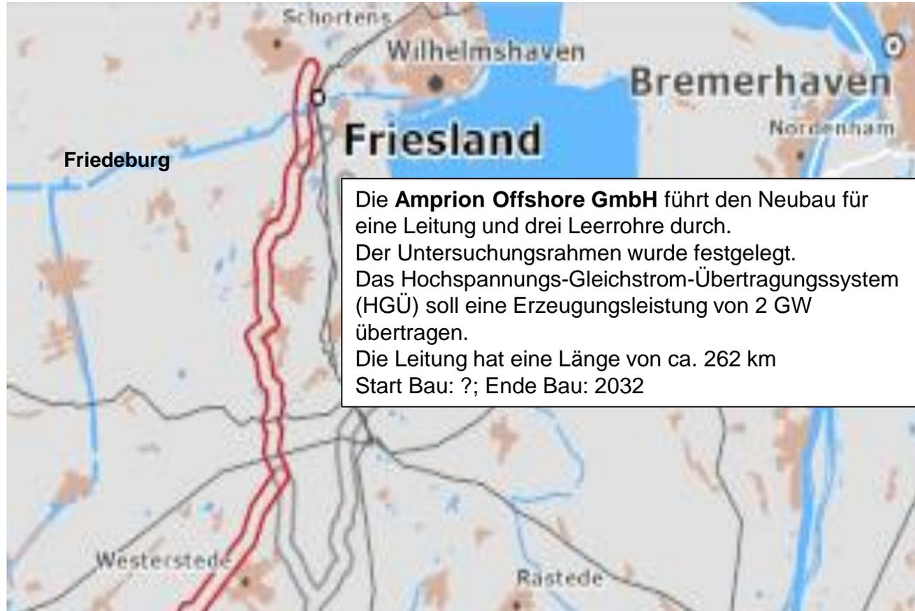
Die **Amprion Offshore GmbH** führt den Neubau für eine Leitung und drei Leerrohre durch. Der Untersuchungsrahmen wurde festgelegt. Das Hochspannungs-Gleichstrom-Übertragungssystem (HGÜ) soll eine Erzeugungsleistung von 2 GW übertragen. Die Leitung hat eine Länge von ca. 262 km
